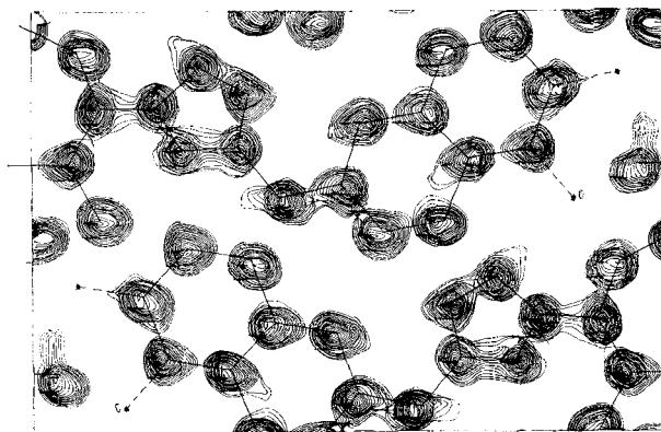
Abb. 15. Zweidimensionale Fourier-Synthese der Struktur aus Abb. 14 nach Phasenverbesserung über 30 Cyclen. Der Ort der zur Anfangsphaseierung verwendeten Atome vom Gewicht des Phosphors ist mit Sternen markiert.
